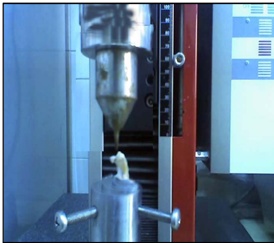
شکل ۱- انجام تست Contilever bending بر روی فمور
