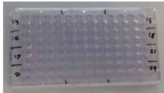
تصویر ۴: میکروپلیت بعد از اضافه کردن اسید استیک آماده قرائت با دستگاه الایزا ریدر
