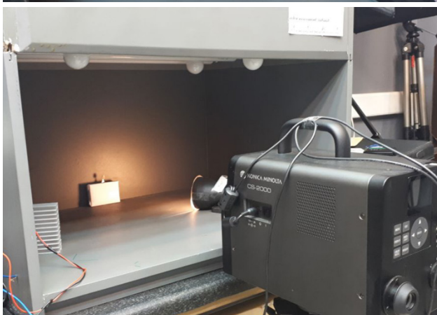
شکل ۲: نمایشی از دستگاه اسپکتروفوتومتر و روش انجام آزمون
