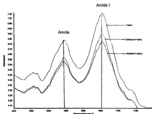
شکل ۶- طیف‌سنجی FTIR تأثیر متومیل آمید بر DNA و پروتئین‌های سلولی را به اثبات می‌رساند. این شکل ماحصل جذب FTIR انعکاسی سلولهای طحال موش در باند آمید (محدوده  $1600-1700\text{cm}^{-1}$ ) پس از برخورد با  $8\text{mg/kg}$  متومیل و  $6\text{mg/kg}$  کلشی‌سین بوده و در حقیقت قدرت FTIR در شناسایی تأثیر متومیل آمید بر DNA و پروتئین‌های سلولی را به اثبات می‌رساند.
