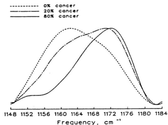
شکل ۱- طیف جذب عبوری FTIR باندهای کششی C-O در ناحیه  $1148-1184 \text{ cm}^{-1}$ . در این شکل سه طیف گوناگون از سه نمونه مختلف بافت کلون که حاصل اختلاط بافت سالم و سرطانی با درصدهای گوناگون است بر روی یکدیگر قرار داده شده تا قدرت افتراق FTIR در تشخیص سرطان به نمایش گذارده شود (محور X طول موج جذبی و محور Y معرف میزان جذب در آن طول موج است).
