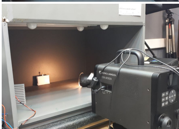
شکل ۲: نمایی از دستگاه اسپکتروفوتومتر و روش انجام آزمون
