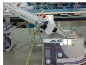
تصویر ۲. تغلیظ عصاره با دستگاه روتاری
