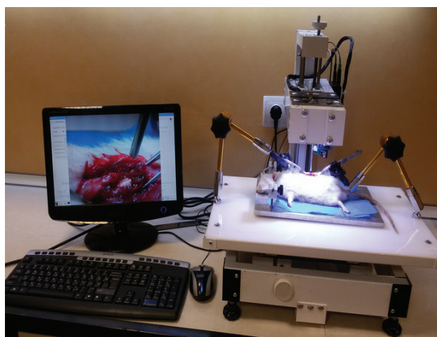
شکل ۱: تصویر کلی از دستگاه NSRC Impactor و نحوه قرارگیری حیوان روی دستگاه
