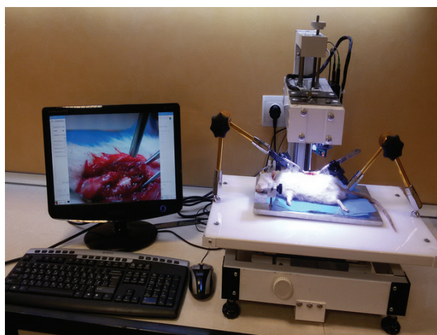
شکل ۴: تصویر کلی از دستگاه NSRC Impactor و نحوه قرارگیری حیوان روی دستگاه
