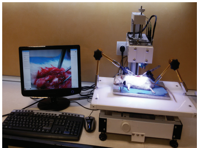
شکل ۱: تصویر کلی از دستگاه NSRC Impactor و نحوه قرارگیری حیوان روی دستگاه
