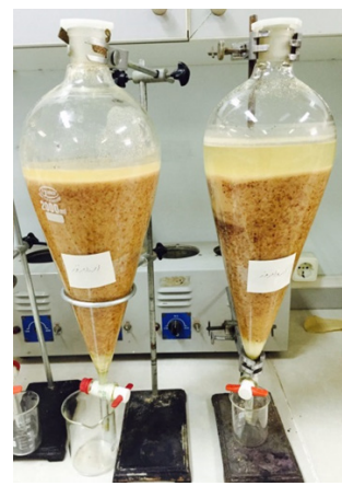
تصویر ۱. روش عصاره‌گیری پرکولیشن.
