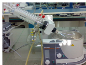
تصویر ۲. تغلیظ عصاره با دستگاه روتاری
